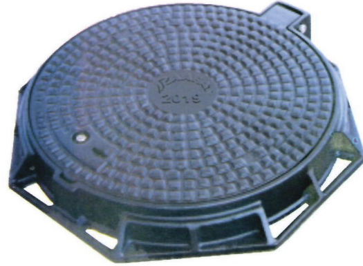
غطاء قطر داخلي ٦٠ سم بمفصلة مربع أو مئمن حمل ٤٠ طن من الزهر المرن
