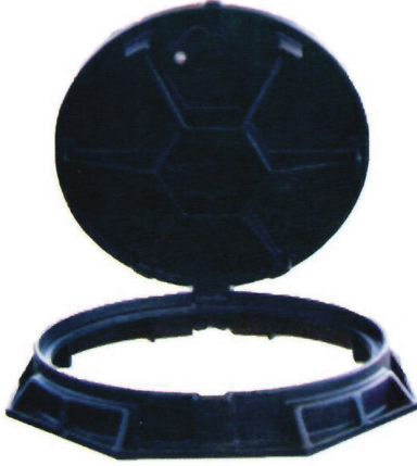
غطاء قطر داخلي ٦٠ سم بمفصلة مربع أو مئمن حمل ٤٠ طن من الزهر المرن
