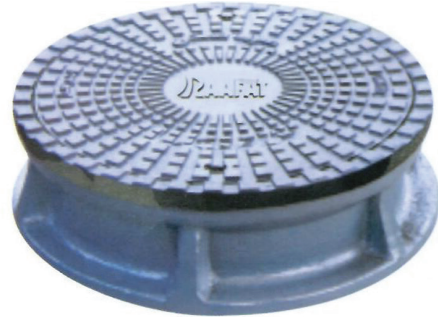
غطاء ٢٨٥ كيلو نموذج الهيئة قطر داخلي ٦٠ سم من الزهر الرمادي
